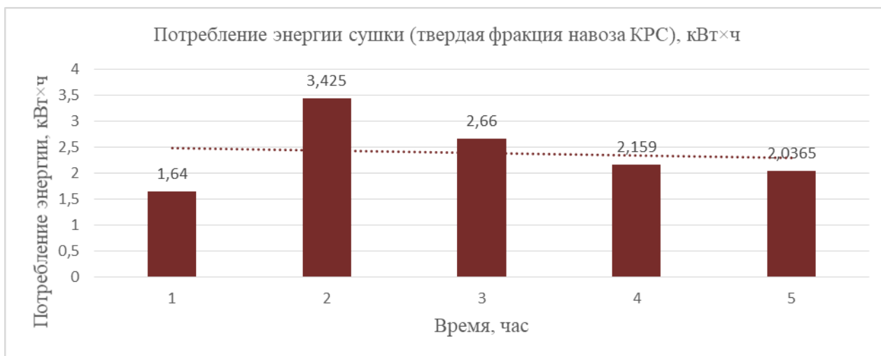
Рис. 3. Потребление энергии при сушке твердой фракции навоза КРС Fig. 3. Energy consumption during drying of the solid fraction of cattle manure
