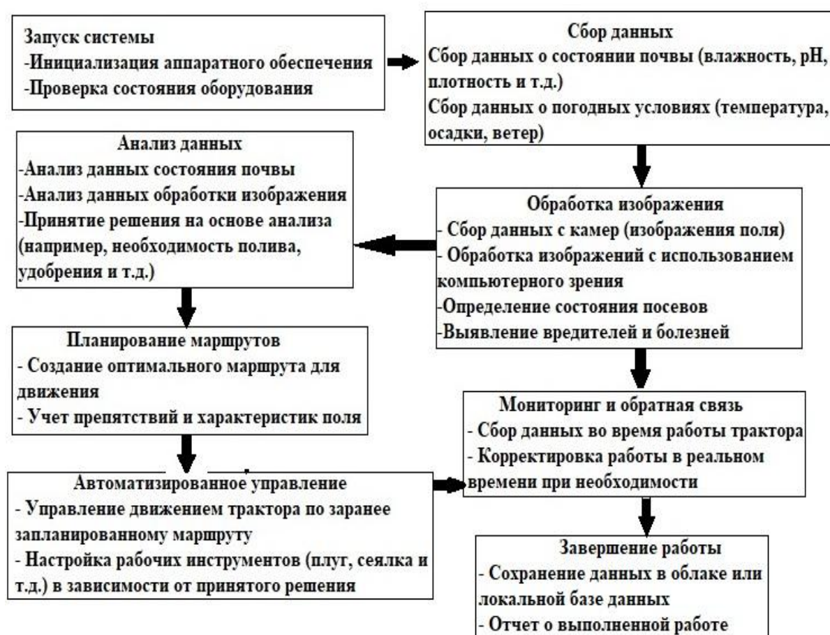
Рис. 1. Блок-схема работы трактора с автоматизированным управлением, компьютерным зрением и анализом почвы
