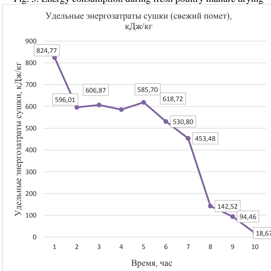
Рис. 6. Удельные энергозатраты сушки свежего помета на кг удаленной влаги Fig. 6. Specific energy consumption for drying fresh poultry manure per kg of moisture removed
